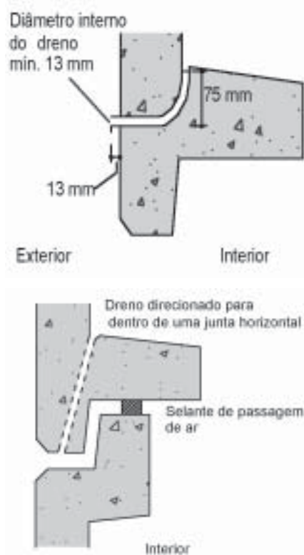
Figura 2 - Detalhes em corte de alternativas de posições dos tubos de drenagem ( a partir de BROOKES, 1998 ).
