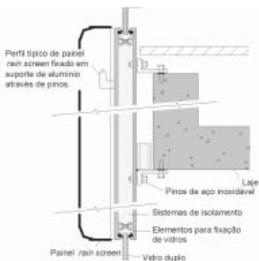
Figura 39 - Corte esquemático de painel com rainscreen (a partir de BROOKES, 1998).
