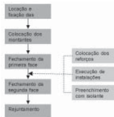
Figura 43 - Seqüência de montagem de divisórias em chapas de gesso acartonado (a partir de TANIGUTI, 1999).
