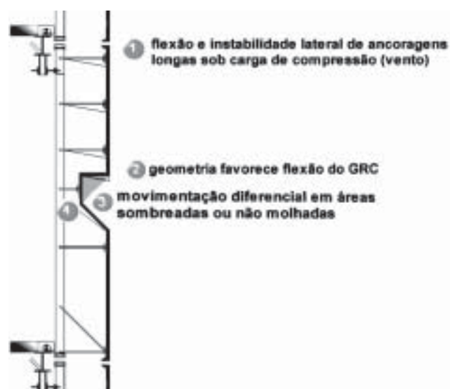
Figura 22 - Influência da geometria dos painéis sobre a natureza das tensões atuando na camada de GRC (SILVA, 1998 b ).
