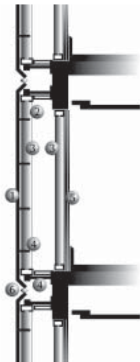
Figura 20 - Sub-componentes do sistema de vedação dos painéis de GRC mais utilizados (SILVA, 1998b).
