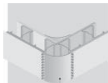
Figura 45 - Arremate de canto utilizando perfil curvo (a partir de MITIDIERI FILHO, 1997).
